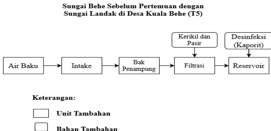
**Gambar 3.6** Diagram Alir Sistem Pengolahan Air Bersih T5
